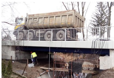
Rysunek 25 Obciążenie próbne mostu kompozytowego w Nowej Wsi oraz przykładowe wyniki pomiarów odkształceń (dzięki uprzejmości SHM System)
